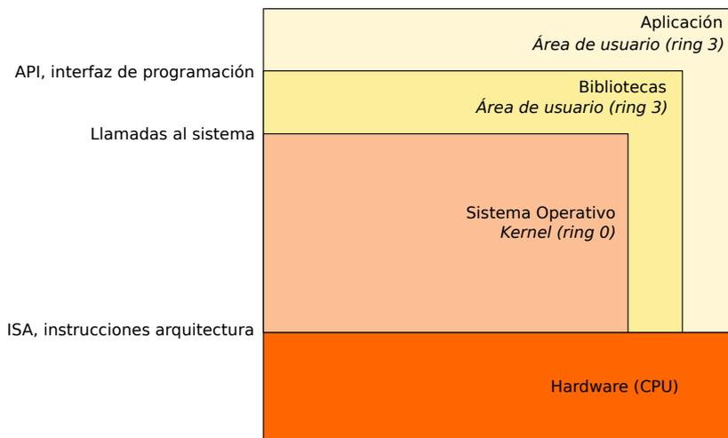
Figura 1.6: Estructura del sistema.
