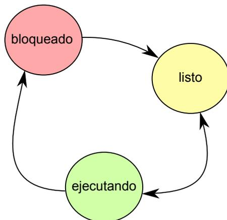
Figura 3.4: Los posibles estados simplificados de un proceso y sus transiciones.
