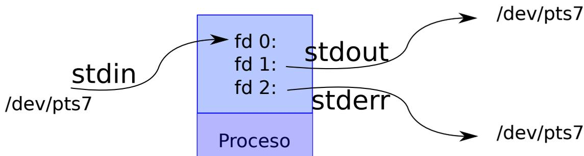
Figura 2.5: Entradas y salidas de un proceso
