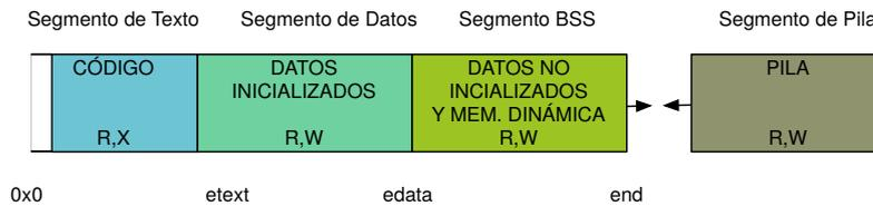
Figura 3.1: Representación de los segmentos de un proceso.
