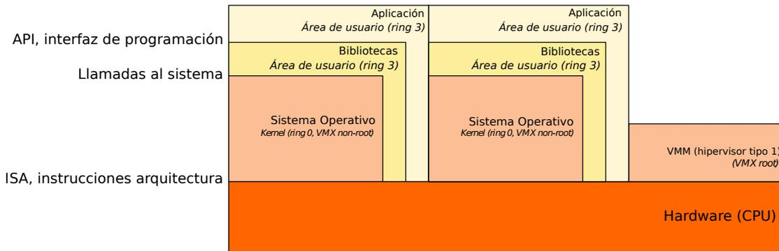
Figura 1.9: Estructura con virtualización asistida por hardware.
