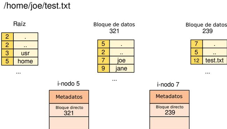
Figura 4.5: Ejemplo para resolver una ruta en Unix.
